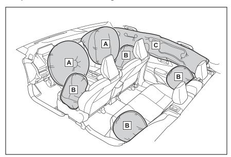
A Coussin gonflable SRS du conducteur/coussin gonflable SRS du passager avant
