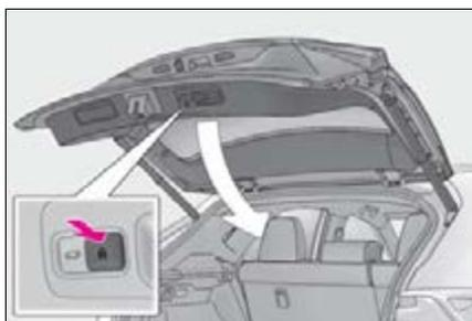
■ **Closing the back door using the back door handle**
